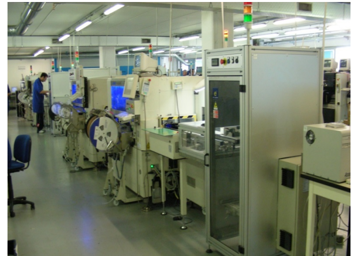
Linea di montaggio SMT composta da 2 Pick&Place e un forno a rifusione
